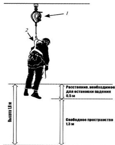
Рис. 5.3 Пример расчёт запаса высоты при использовании жёсткой анкерной линии или анкерной точкой, установленной с фактором падения высоты 0.
